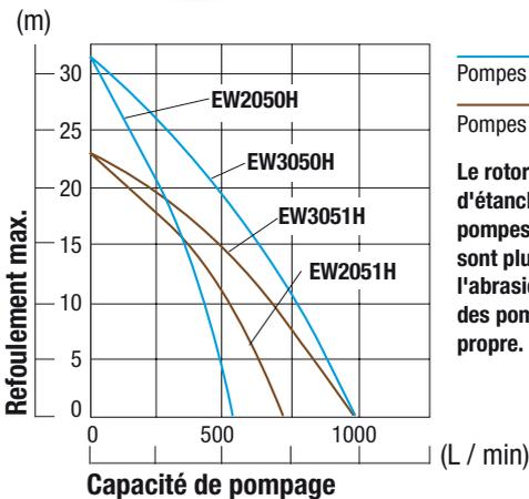
Le rotor et les parties d'étanchéité des pompes à eau chargée sont plus résistantes à l'abrasion que celles des pompes à eau propre.
