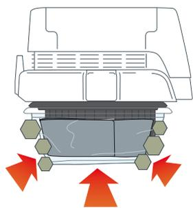
Lorsque l'aspirateur est en fonctionnement, le préfiltre se rétracte pour compresser l'absorbeur et ainsi il épouse parfaitement l'absorbeur et le filtre, rendant l'aspiration particulièrement efficace.
