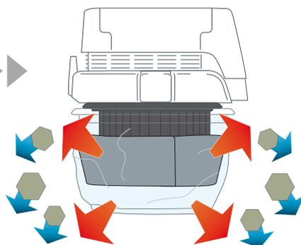
Lorsque l'aspirateur est arrêté, l'absorbeur se dilate de nouveau pour retrouver sa taille originale et ainsi éjecte automatiquement la poussière accumulée sur le préfiltre.
